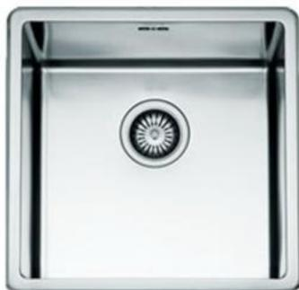
Le vasche e vaschette in acciaio inox AISI 304 sono realizzate in un unico pezzo senza giunzioni con bordi e spigoli arrotondati ed antinfortunistici a mezzo di stampaggio e sono fornite complete di griglia di raccolta inferiore e di scarico filettato.
